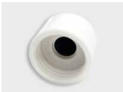
СОЕДИНИТЕЛЬНЫЙ РАЗЪЕМ GL 45 GL45 является стандартным для клапана DN25. Корпус из ПТФЭ с внутренней прокладкой из VMQ (силиконовой резины) гарантирует максимальную герметичность.
